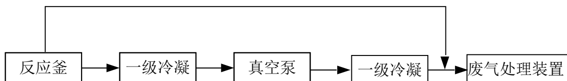
图 5.2-1 本项目有机废气收集管线走向示意图
