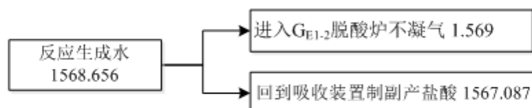
图 3.4-11 气相白炭黑产品 (E1) 生产线水平衡图 单位: t/a
