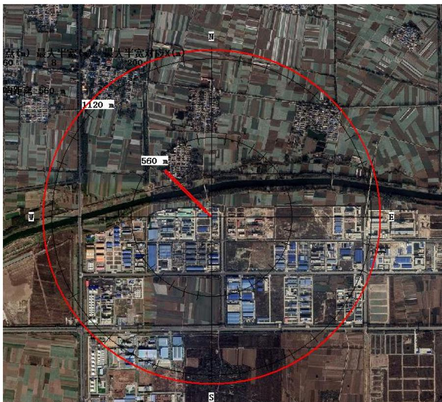
图11.7-1 预测时刻5min、阈值95mg/m<sup>3</sup>条件下CO气体扩散廓线图
