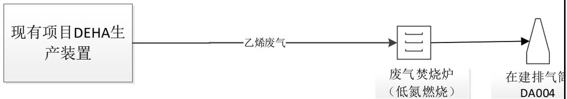
图 2-6 在建项目一有组织废气收集治理措施示意图
